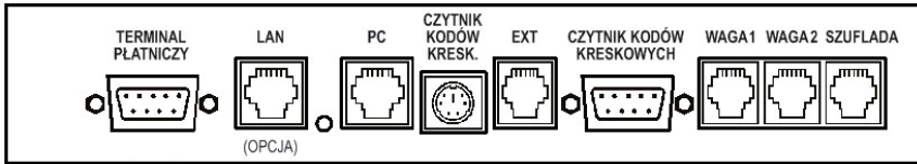
Rys. 1-2 Widok na złącza interfejsów (od spodu kasy)
