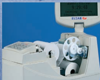
Szybkie mechanizmy drukujące wykorzystujące rolki papieru o długości 40 m
